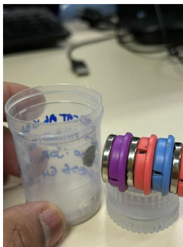
Figura 6 - Demonstração da propriedade magnética do fotocatalisador.
