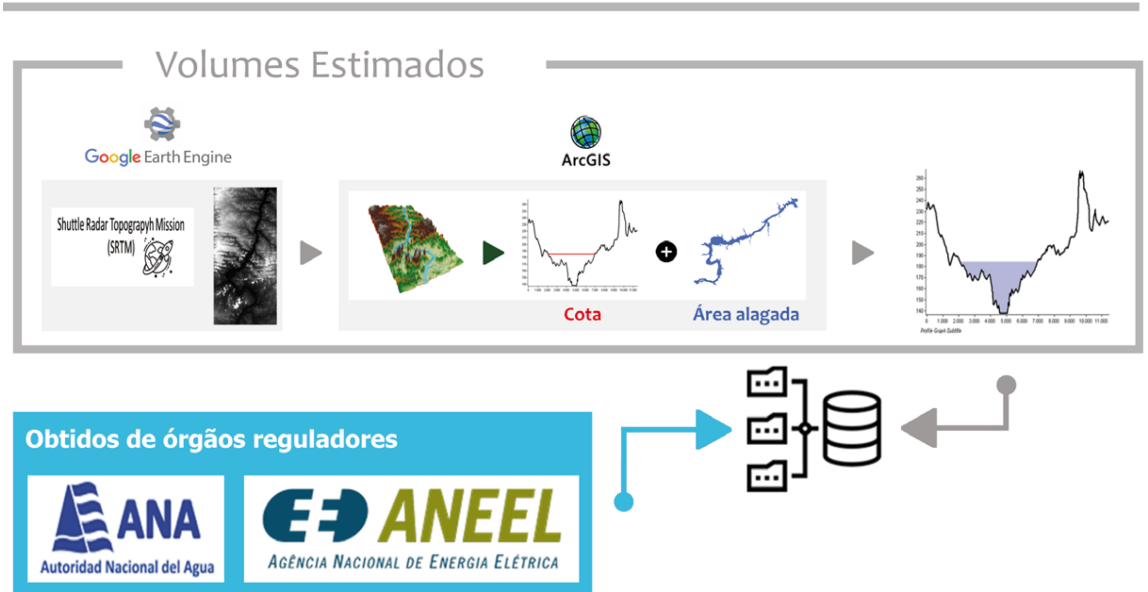
Figura A3. Bases de dados e metodologia utilizada para estimativa dos volumes dos reservatórios hidrelétricos existentes na região amazônica.
