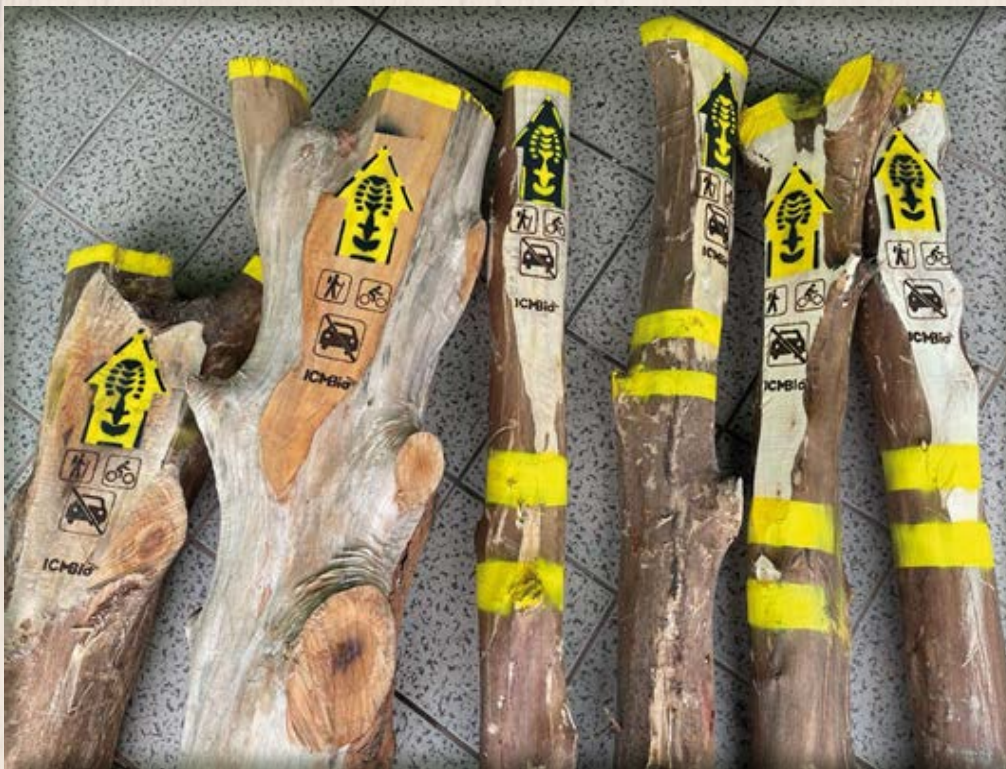
Totens utilizados nos trechos de travessia de praia nos Caminhos da Baleia Franca, aproveitando troncos rústicos de casuarinas exóticas abatidas, na APA da Baleia Franca (SC). Detalhe para a utilização da pegada em cores para diferentes sentidos e da comunicação utilizando pictogramas. A área de aplicação fora aplainada utilizando plaina elétrica. (Foto Paulo Faria).
