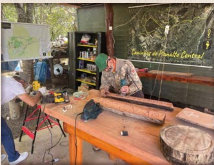
Prática de confecção de placas em baixo relevo utilizando tupia laminadora e tupia de mão, em madeira reaproveitada de controle de exóticas (eucaliptos) ou de podas urbanas. (Foto Paulo Faria).
