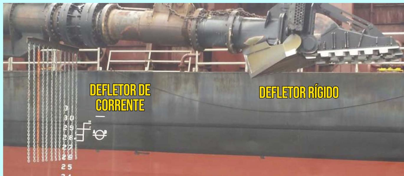
Figura 16: Exemplos de defletores flexível (de correntes) e rígido instalados em uma draga. Fonte: Porto do Açu (2021).
