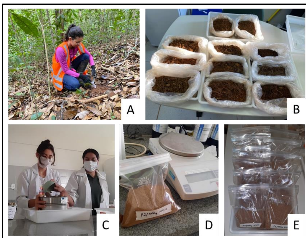
Figura 4. Preparo das amostras de solo para análise de biomassa microbiana. Coletas de solo na FLONA de Carajás (A); secagem das amostras ao ar (B); processamento das amostras de solo que foram peneiradas e pesadas para a análise em laboratório especializado (C, D e E).
