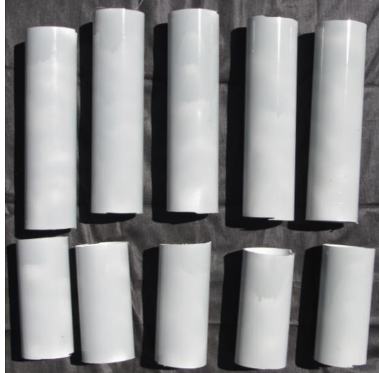
Figura 2: Modelos confeccionados de cano PVC de 75mm de diâmetro pintados em tom de cinza.
