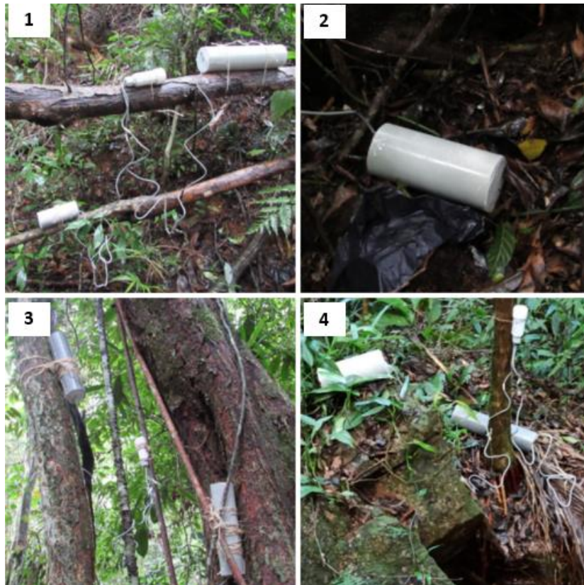
Figura 7: Modelos confeccionados de PVC e Hobbo Data Logger instalados nos microhabitats selecionados no parque Nacional da Tijuca: 1) Modelos dispostos em poleiros de até 2m de altura, 2) Modelo disposto no folhiço, 3) Modelos dispostos em poleiros de 2 a 4m de altura e 4) Modelos dispostos na pedra.
