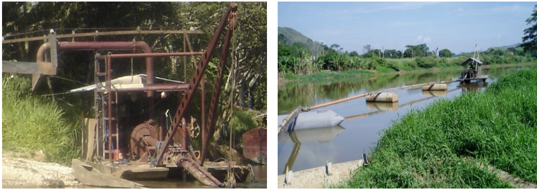
Figura 24 – Equipamentos utilizados na extração de areia (“areiais”) do leito do Rio Paraíba do Sul e afluentes. Fotos: INEA, 2009.
