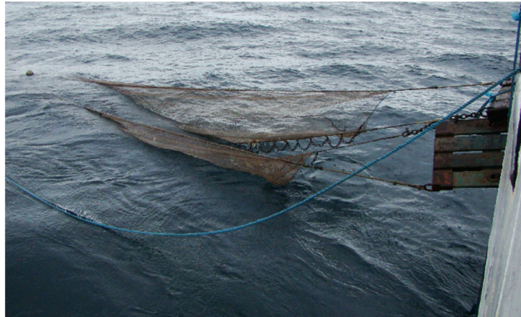
Figura 2. Rede de arrasto com portas utilizadas no Np Soloncy Moura.
