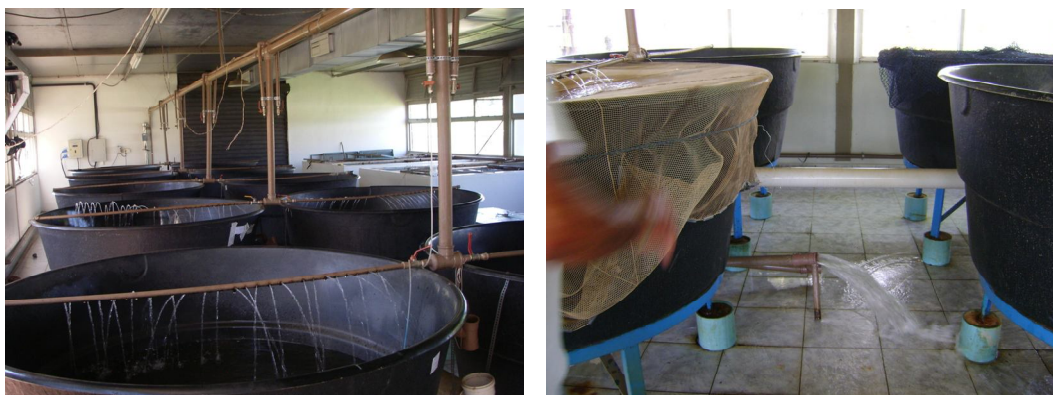
Figura 11 – À esquerda, laboratório de quarentena contendo caixas de polipropileno de mil litros com circulação de água constante; à direita, escoamento de água para limpeza. Foto: Carla N. M. Polaz (2010)
