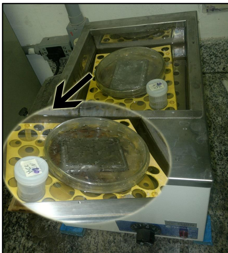
Figura 11: Banho-maria e o uso de Nitrato de Prata para identificação das RONS.
