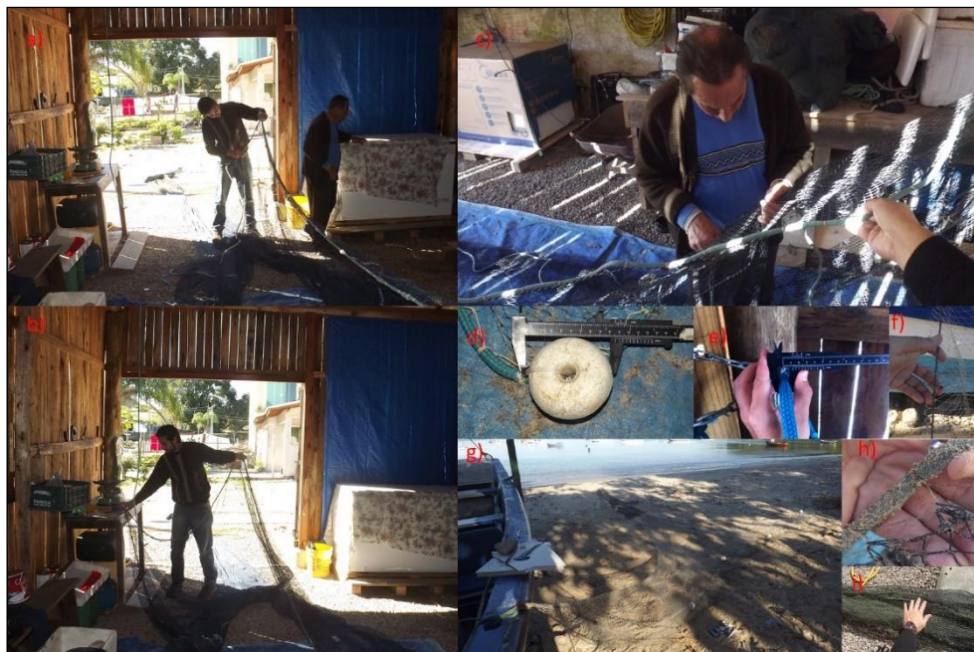
Figura 4- Medição das redes de pesca artesanal de arrasto de camarão na APAA: a) Contagem da quantidade de encalças na rede controle do pescador-pesquisador Adriano. b) Contagem do número de malhas entalhadas, rancho de pesca do Adriano. c) Auxílio do pai do pescador-pesquisador na medida das dimensões das redes. d) Contagem e medição do diâmetro dos flutuadores. e) Medição do diâmetro máximo da tralha das redes. f) Contagem do número de malhas entalhadas no cabo lateral da rede do pescador João, Fazenda da Armação. g) Materiais utilizados para medição das redes, Fazenda da Armação. h) Malhas entalhadas na manga da rede, Fazenda da Armação. i) Medição do número de malhas no pré-sacador com dispositivo de redução da fauna acompanhante “Balão”.
