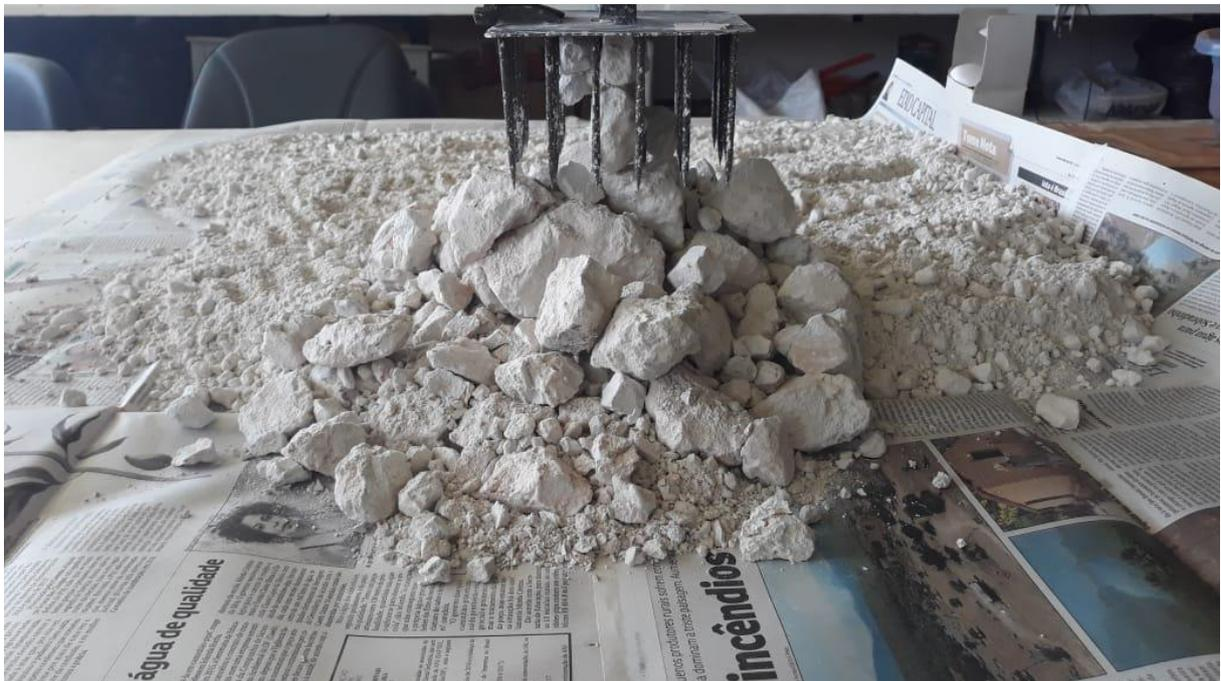
*Figura 3. Saprólito destorroado e seco ao ar*
