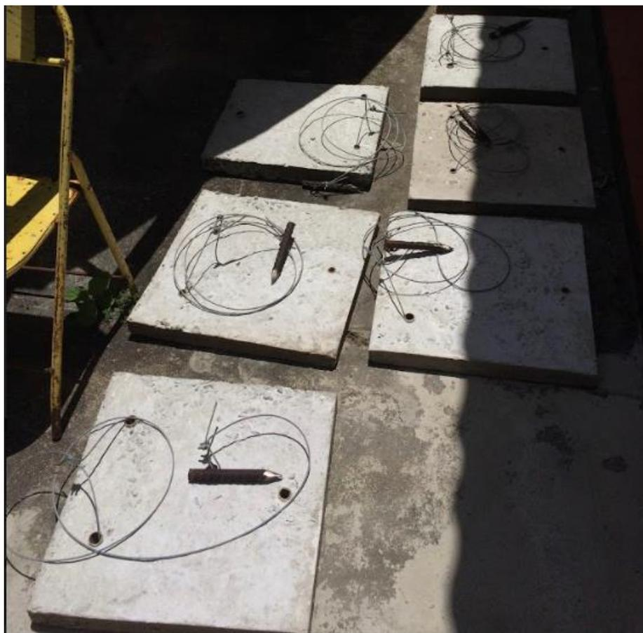
**Figura 1.** Placas de concreto totalmente finalizadas, com os cabos de aço e o espontão produzido através de um vergalhão de uma polegada afiado de forma sextavada para fixação nas rochas.
