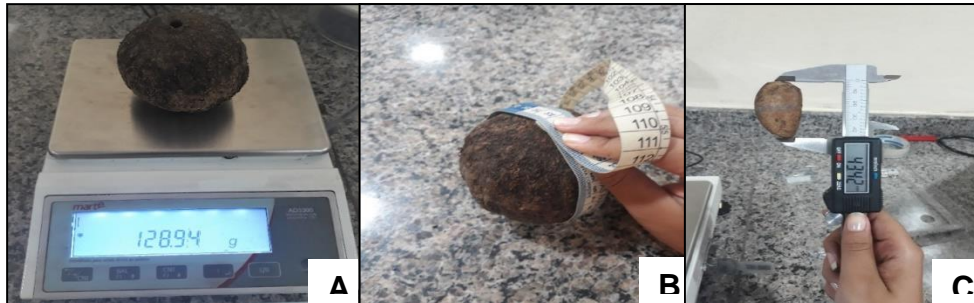
Figura 2. (A) Peso da massa do ouriço; (B) mensuração dos diâmetros externos do ouriço; e (C) mensuração da semente com paquímetro digital. Fonte: Autoral (2019).
