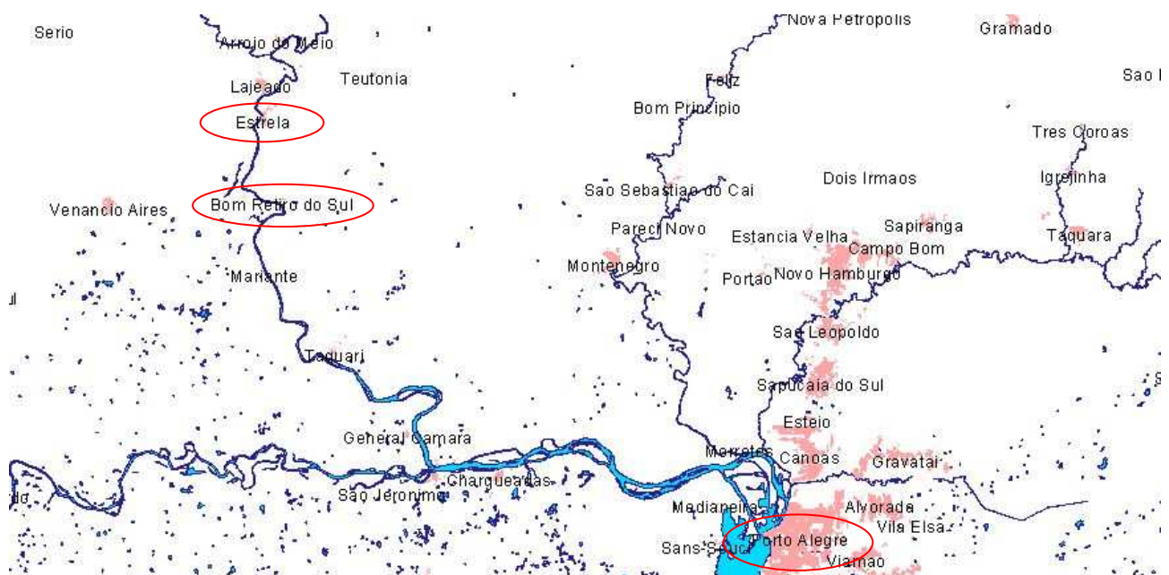
Figura 1. Trecho do sistema de drenagem Jacuí-Patos (detalhe). Eclusa de Bom Retiro (Bom Retiro do Sul) permite conectividade para navios entre Estrela e Porto Alegre e reduz a conectividade para peixes.
